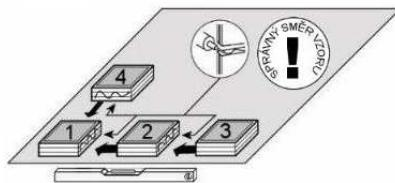
3. Pro jednodušší montáž a z důvodů mechanického kotvení jednotlivých dílců, doporučujeme vlepit kotvu M6 viz. obrázek.
