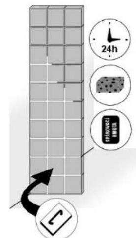
5. Po zatvrdení lepidla se celá slepěná stěna vyspáruje spárovací hmotou pro spáry o velikosti 1 cm. Postup spárování dle výrobce spárovací hmoty.
