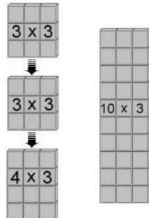
2. Na vodorovné podložce si slepíme jednotlivé segmenty. Z důvodu manipulace - váhy ( 1m<sup>2</sup>- 75kg), doporučujeme maximální rozměr segmentu 4x4 VERRALIE.
