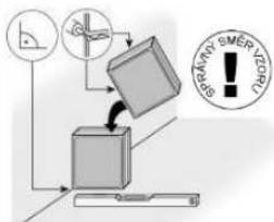
3. Takto připravená tvárnice se přitiskne k podkladu. Tvárnice se musí kontrolovat, jak ve vodorovném, tak i ve svislém směru.
