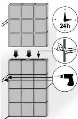
4. Po řádném zatvrnutí lepidla (24h), dílce sestavíme: Nejprve osadíme spodní díl (3x4) a ukotvíme kotvou M6. Poté na spodní díl přilepíme a nakotvíme prostřední díl (3x3).
