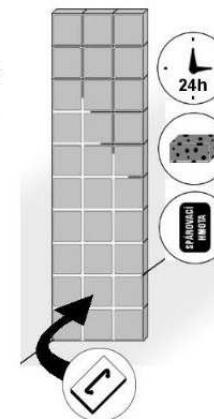
6. Po zatvrnutí lepidla se celá slepená stěna vyspáruje spárovací hmotou pro spáry o velikosti 1 cm. Postup spárování dle výrobce spárovací hmoty.
