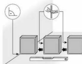
4. Další tvárnice klademe stejným způsobem. Vždy se musí kontrolovat bezchybné umístění každé jednotlivé tvárnice a případné nepřesnosti korigovat.
